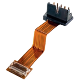
Programmieradapter Programmieradapter, adaptiert von Rastermaß 0,50 mm auf Rastermaß 2,54 mm
